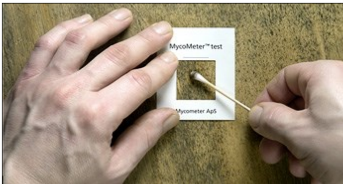
MycoMeter-testen™ anvendes til at bestemme mængden af svamp, der er til stede på et givet materiale. (Kilde: Mycometer.dk)
